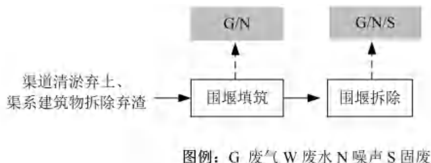
图3.11-1 导流施工工艺流程及产排污节点图
