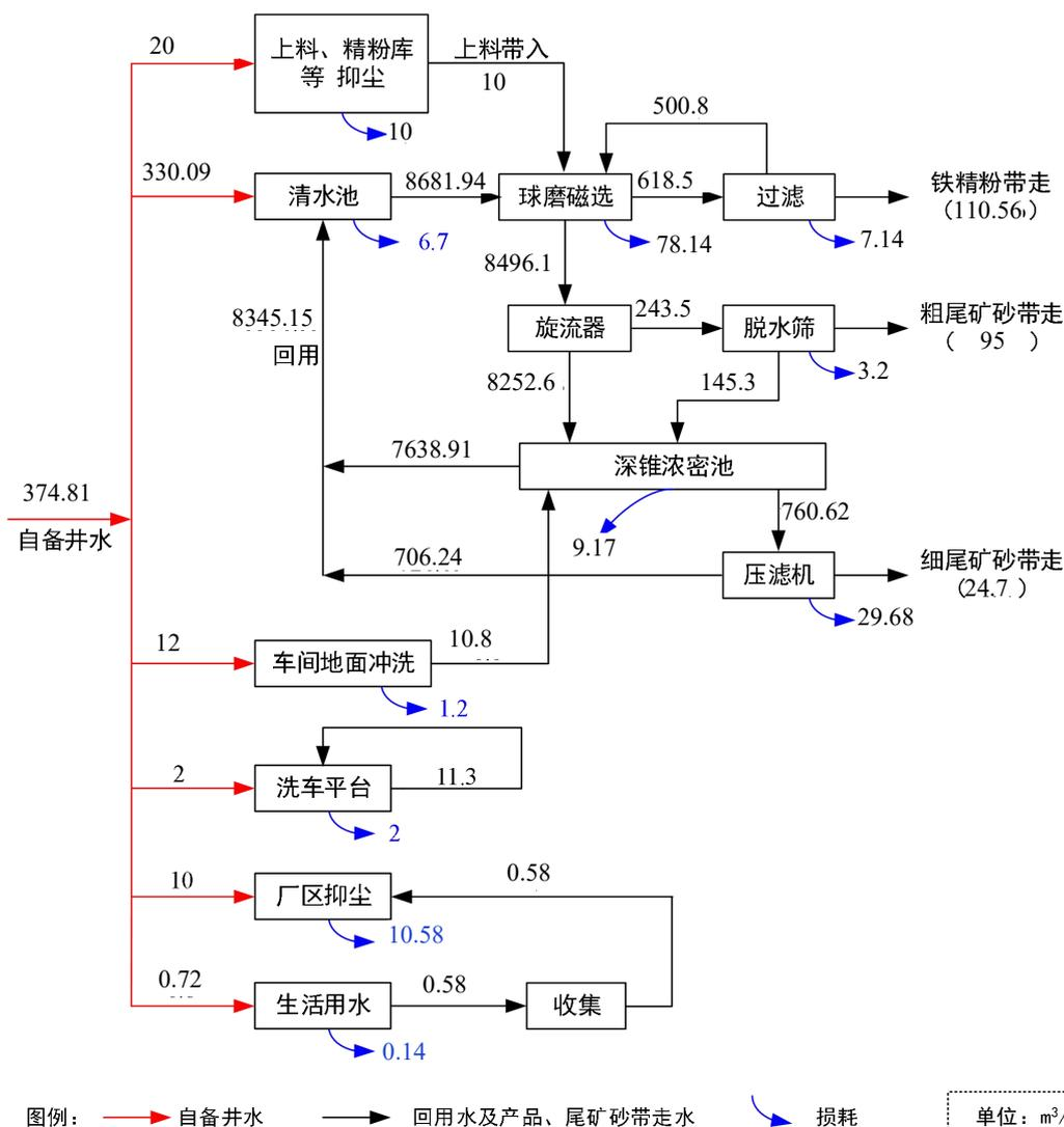
图 3.2-1 改扩建实施后全厂水平衡图
