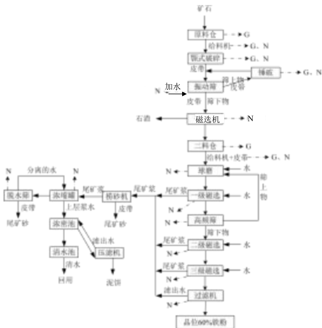
图 3.4-1 项目生产工艺流程及排污节点图
