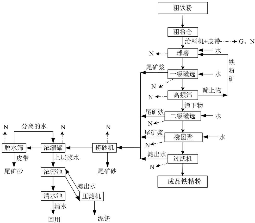
图 3.4-3 精选线工艺流程及排污节点图
