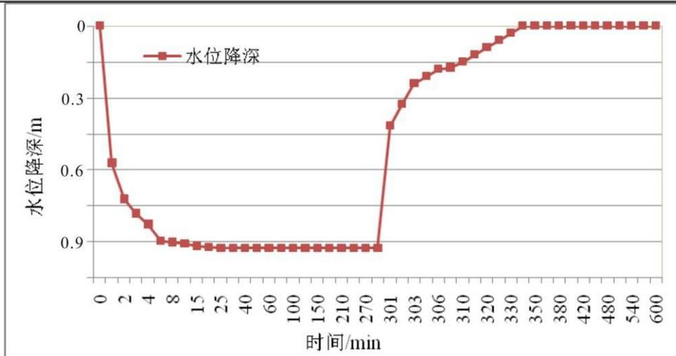
图5.2-9 项目厂区抽水试验降深-时间曲线
