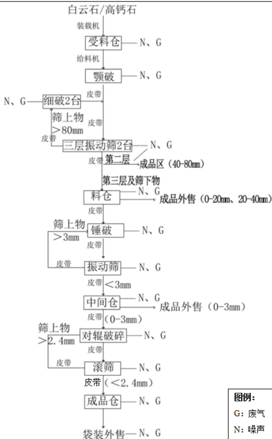
图 2-2 白云石及高钙石加工工艺流程及排污节点图
