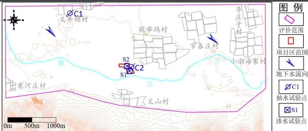
图 5.2-6 项目区抽水试验和渗水试验位置图
