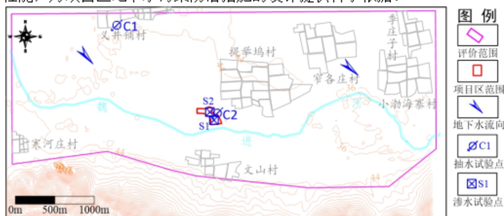
图 5.2-6 项目区抽水试验和渗水试验位置图
