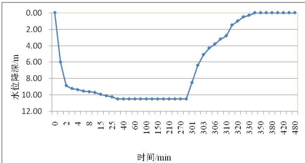
图5.2-14 大曹各寨村内抽水试验水位降深-时间曲线
