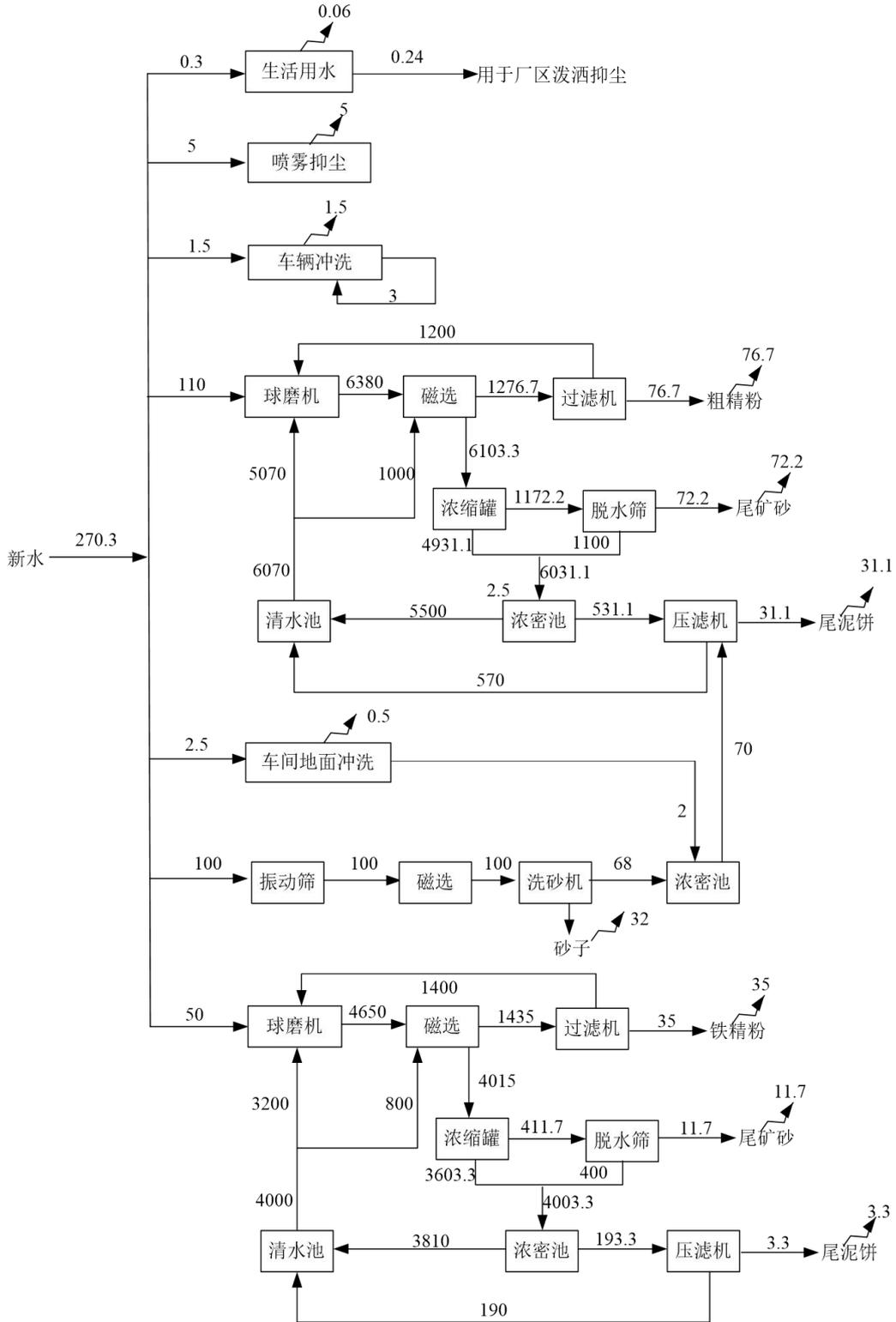
图 3.2-1 改建项目实施后全厂水平衡图 m³/d
