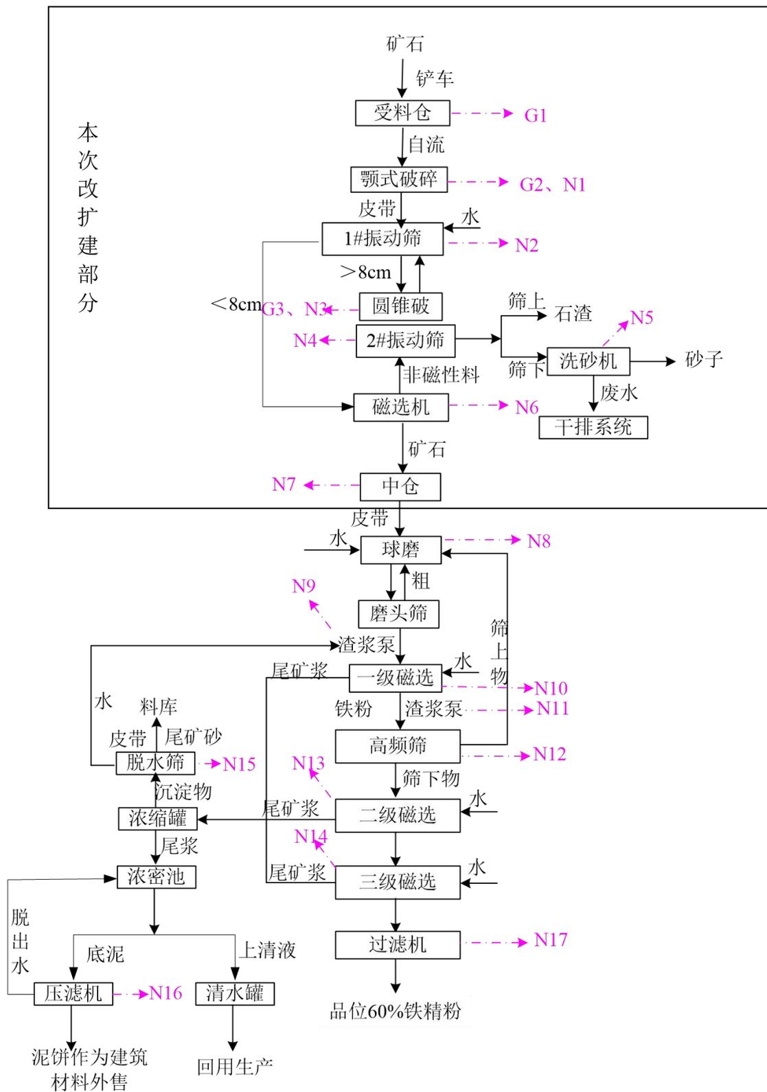
图 3.3-1 破碎粗选生产工艺流程及产排污环节分析
