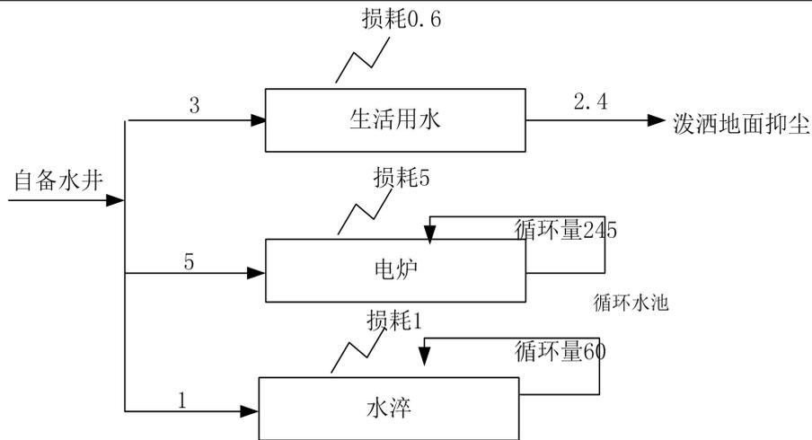
图 2-2 现有工程给、排水平衡图 m<sup>3</sup>/d
