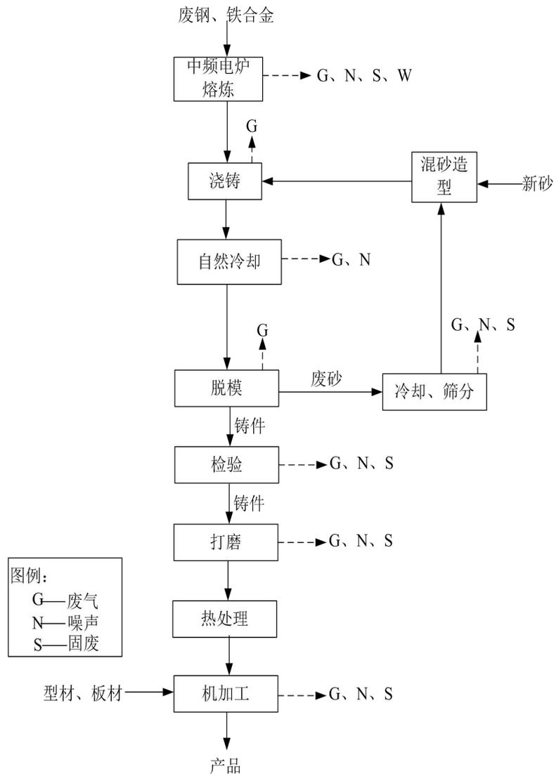
图 2-1 现有工程中频电炉砂型铸造工艺流程及排污节点图
