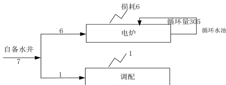
图 2-3 技改项目水平衡图 m<sup>3</sup>/d
