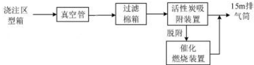
图 4-1 挥发性有机物治理工艺流程图
