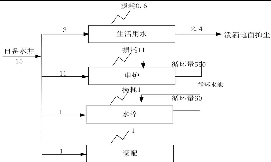
图 2-3 项目技改后全厂水平衡图 m<sup>3</sup>/d
