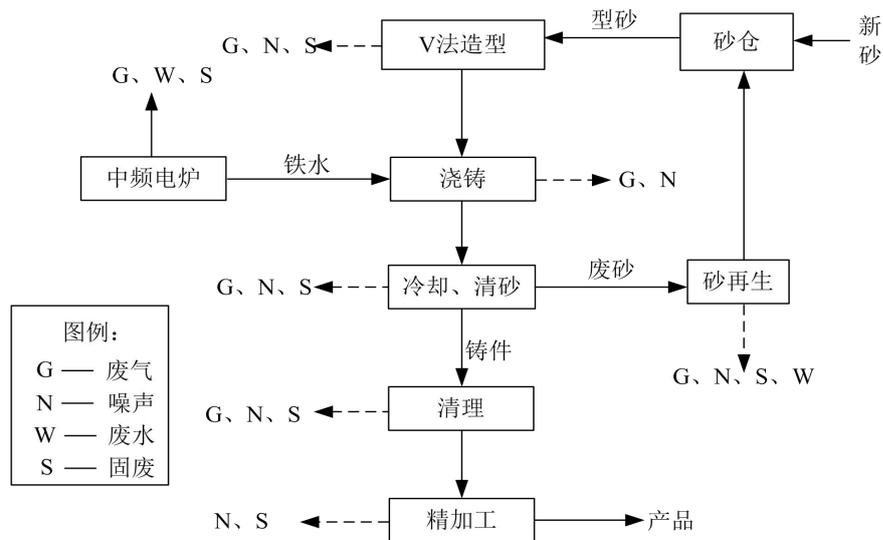
图 2-4 项目生产线工艺流程及产排污节点图
