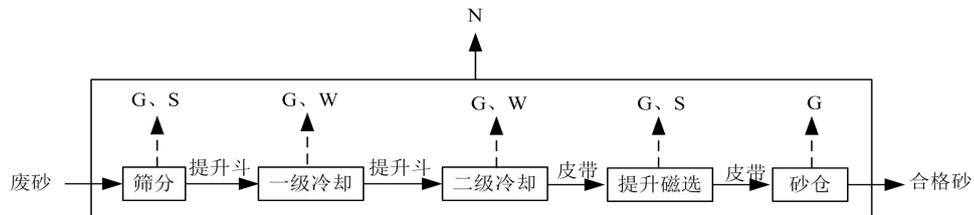
图 2-5 砂再生生产工艺流程及产排污节点图
